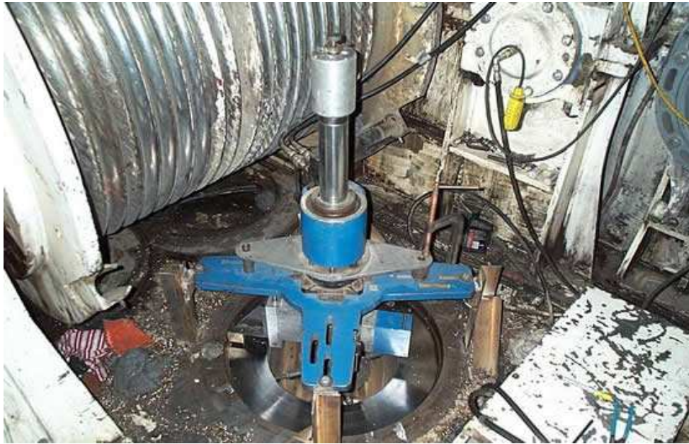
Foto: Barrenado y refrentado del agujero del pin central de una pala P&H 4100
